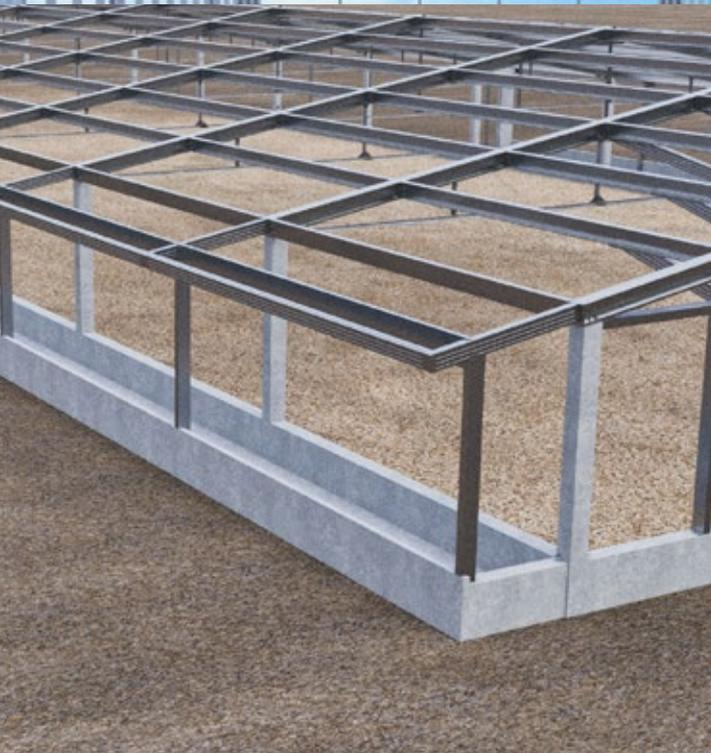
**Estructura lateral para instalación de las placas de evaporación.**
