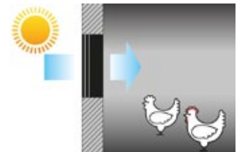
Reducción de luminosidad con la utilización de Light Trap
