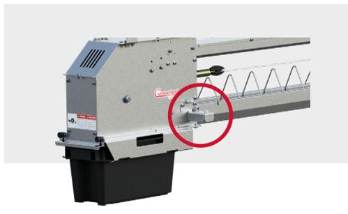
**Sensor de seguridad** al final del circuito, con función de detener el movimiento de la cadena en caso de una falla en el ajuste, descarga de ración o incluso una falla en el sensor de detección, eliminando daños en el funcionamiento.
