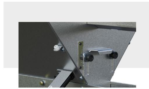
**Regla niveladora de ración** con una variación de 2,5mm entre los ajustes, con encaje para evitar desajustes y ofrecer un mayor control. Sensor para detectar la presencia del alimento e iniciar el movimiento de la cadena para su distribución, deteniéndose cuando el alimento se acaba.
