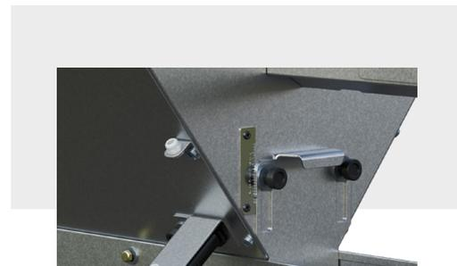
**Régua niveladora de ração** com variação de 2,5mm de diferença entre as regulagens e encaixe para evitar desregular e maior controle. Sensor para detectar a presença da ração e iniciar o movimento da corrente para distribuição e parada quando a ração terminar.
