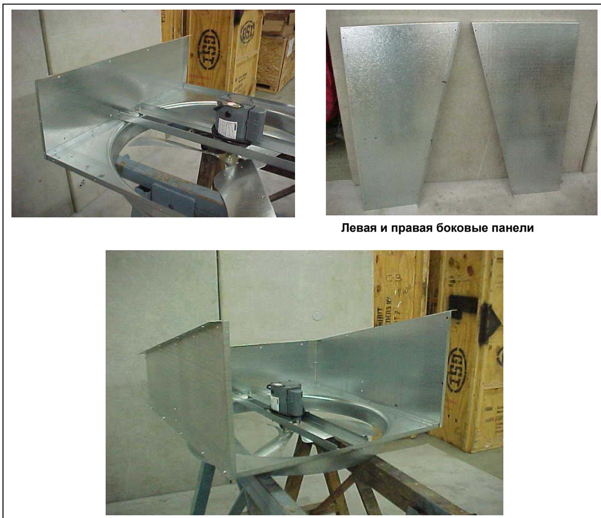
Шаг 2D для конусных вентиляторов 36" с наклонной стенкой
