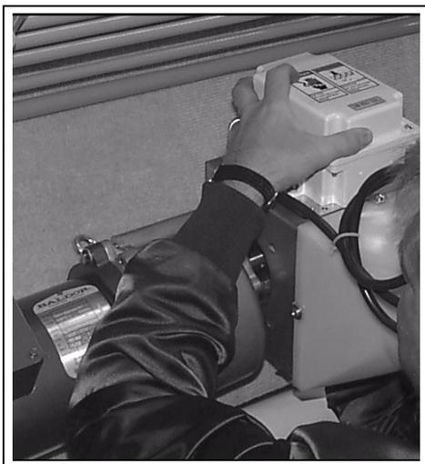
Рисунок 5R Установка блока управления на привод
