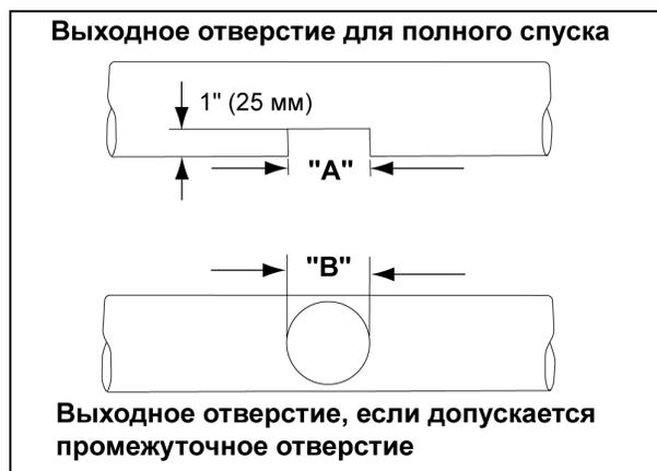
Рисунок 5L. Схема вырезания выходных отверстий
